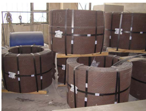
Obrázek 55 – Předpínací lana ve svitcích (jeden svitek: délka lana 1635 m, hmotnost 1920 kg)
