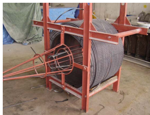
Obrázek 55 – Předpínací lana ve svitcích (jeden svitek: délka lana 1635 m, hmotnost 1920 kg)
